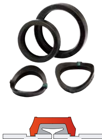
[표준형 고무링 (Standard Gasket)] 유동식, 고정식 조인트의 모든 모델에 적용되는 표준형 고무링입니다.
